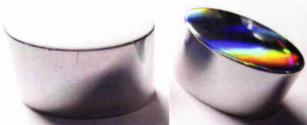
図3 村田金箔のブースで実演していたホットスタンプによる加飾サンプル
