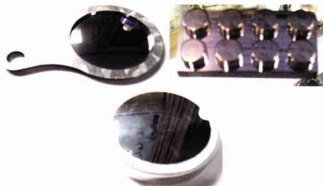
図7 成形機横でスパッタを行った直後のサンプル 左上:ニクニ, 右上:日本製鋼所, 下:東芝機械エンジニアリング
